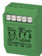
Télérupteur mixte Filaire/Radio - sortie contact sec libre de potentiel (10A) permettant le pilotage de tous types d'éclairages ainsi que portails, gâches etc... Compatible avec tous les émetteurs YOKIS, fonctionne en mode télérupteur, impulsionnel et maintenu. Temporisable de 2" à 4h. Centralisable par fil pilote ou en radio. Existe également en version antenne déportée (MTR2000ERPX).
