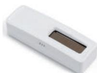
Le Capteur de température et d'humidité EnOcean® NodOn® est un capteur sans fil et sans pile. Associé à une centrale domotique, il permet de remonter la température d'une pièce avec une précision de moins de 0,2°C sur une plage de mesure de 0°C à 40°C et le taux d'humidité d'une pièce avec une précision de 5% r.h.
