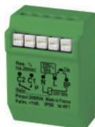
Télérupteur mixte Filaire/Radio - sortie contact sec libre de potentiel (10A) permettant le pilotage de tous types de charges : éclairages, portails, gâches, vmc etc. Compatible avec tous les émetteurs YOKIS, fonctionne en mode télérupteur, impulsionnel et maintenu. Temporisable de 2" à 4h. Centralisable par fil pilote ou en radio. Existe également en version antenne déportée (MTR2000ERPX).
