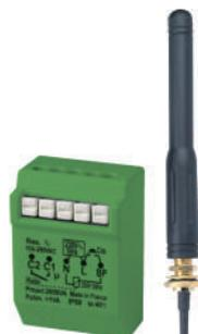
Télérupteur mixte Filaire/Radio - sortie contact sec libre de potentiel (10A) permettant le pilotage de tous types de charges : éclairages, portails, gâches, vmc etc. Compatible avec tous les émetteurs YOKIS, fonctionne en mode télérupteur, impulsionnel et maintenu. Temporisable de 2" à 4h. Centralisable par fil pilote ou en radio. Antenne déportée. Fixation d'antenne incluse.
