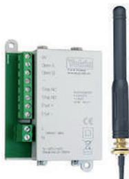
Micromodule radio permettant de gérer les automatismes de portails FAAC (vérifier la compatibilité du moteur): pilotage à distance des portails battants ou coulissants par télécommande ou depuis un smartphone ou une tablette et visualisation en temps réel de l'état ouvert / fermé avec l'application Energieasy Connect.
