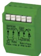
Micromodule radio encastré permettant la centralisation de volets roulants, de volets battants ou de stores par boutons poussoirs exclusivement ou avec les télécommandes radio Yokis. Associé au contrôleur energieasy connect, cet émetteur permet le pilotage en local ou à distance de ces ouvrants depuis l'application mobile. Compatible avec tous les moteurs disposant de 3 fils (commun, ouverture, fermeture). Les butées doivent exclusivement être mécaniques.
