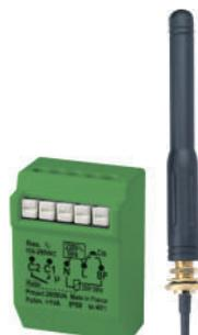
Télérupteur mixte Filaire/Radio encastré avec antenne extérieure - sortie contact sec libre de potentiel (10A) permettant le pilotage de tous types d'éclairages ainsi que portails, portes de garages, gâches, etc. Compatible avec tous les émetteurs YOKIS, fonctionne en mode télérupteur, impulsionnel et maintenu. Temporisable de 2" à 4h. Centralisable par fil pilote ou en radio. Existe également en version antenne déportée (MTR2000ERPX).
