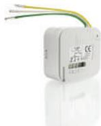
Récepteur sans fil radio qui permet de piloter un éclairage (500W maximum pour les lampes halogènes ou 60W maximum pour les lampes fluo-compactes/Led) en mode on/off. S'installe dans le boîtier d'encastrement.
