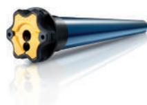
Moteur radio RTS pour tous types de volets roulants. Cage fins de courses électronique. Capacité de la cage, 200 tours. Réglage fins de courses automatique si le volet roulant est équipé de butées et de verrous. Récepteur radio RTS intégré. ATTENTION, LE PROTOCOLE RTS NE PERMET PAS D'AVOIR UN RETOUR D'INFORMATION DE L'EQUIPEMENT.
